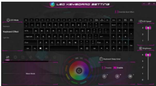
Önyükleme sırasında klavye geçici olarak yanıp söner. Sistem önyüklenirken klavye yanıp sönmeye efektini devre dışı bırakmak için **Önyükleme Efektini Geçersiz** Kıl onay kutusunu tıklatabilirsiniz.
